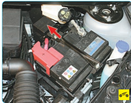
В подкапотном пространстве расположен также блок реле, закрепленный на прижимной планке аккумуляторной батареи.
