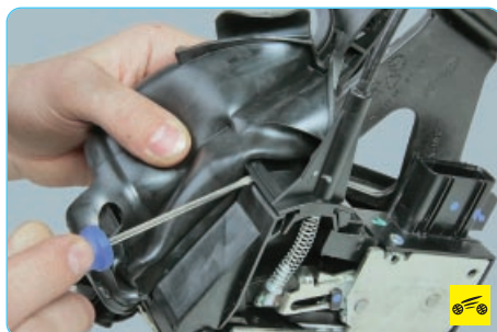
14. ...отогните защитный кожух, отверткой отожмите фиксаторы наконечника...
