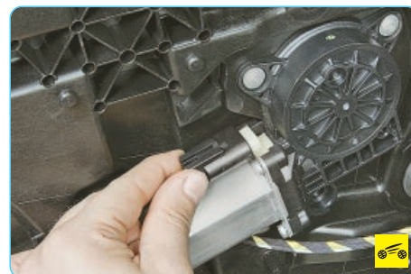
3. Сожмите фиксатор колодки жгута проводов моторедуктора стеклоподъемника...
