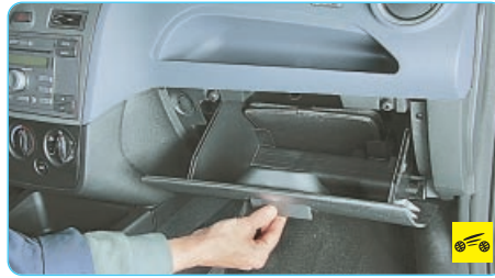
17 – вещевой ящик. Служит для хранения мелких вещей и открывается при нажатии на ручку замка вверх.
