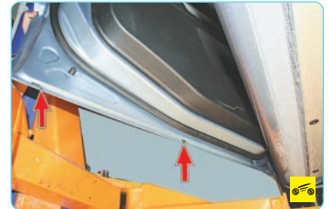
1. Прочистите дренажные отверстия в передних...
