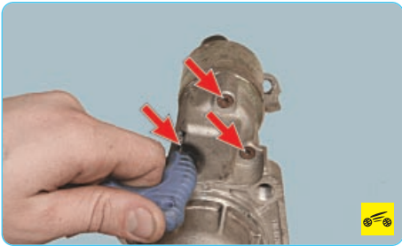
3. Выверните три винта крепления тягового реле к крышке стартера со стороны привода...
