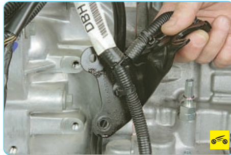
20. ...и отведите от коробки передач кронштейн со жгутами проводов.
