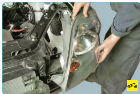
11. Снимите блок-фару (см. «Замена блок-фары», с. 236).
