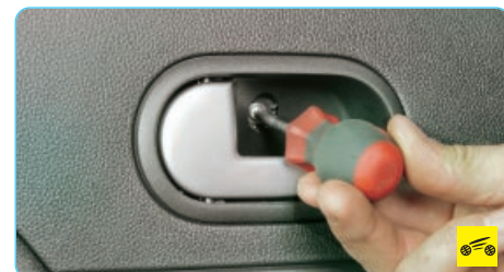
3. Выверните винт крепления внутренней ручки.
