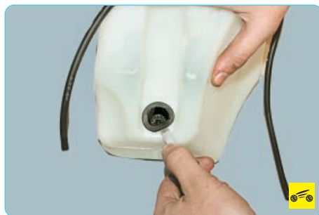
14. Подденьте отверткой уплотнительную втулку электронасоса...
