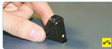
19. ...и извлеките жиклер омывателя из отверстия в капоте.
