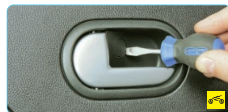
1. Подденьте отверткой заглушку винта крепления внутренней ручки...
