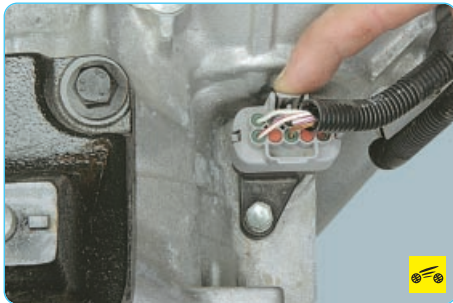
15. Нажмите кнопку фиксатора...
