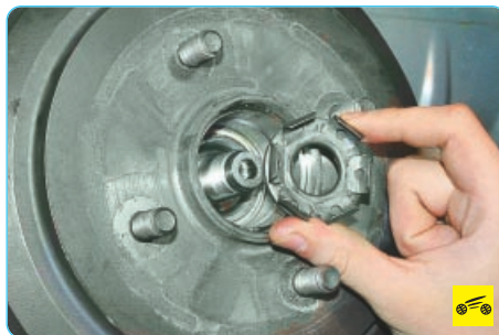
8. ...и снимите стопорную шайбу.
