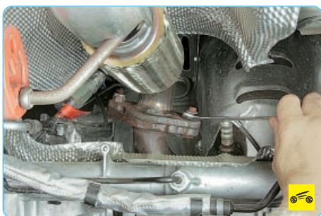
2. Отверните две гайки крепления фланца приемной трубы к фланцу катколлектора...
