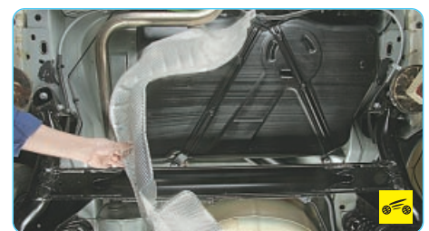
4. ...и снимите задний термоэкран.
