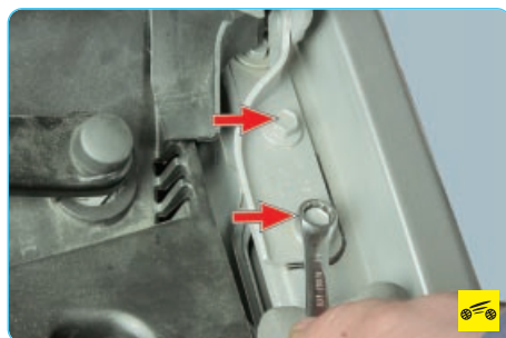
13. Выверните два болта крепления петли капота к кузову.
