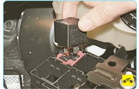
4. Извлеките неисправное реле. 5. Установите новое реле и снятую крышку в порядке, обратном снятию.
