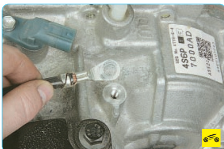
18. ...и отсоедините от картера коробки передач «массовый» провод.
