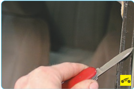
9. Срежьте старый шов, оставляя тонкий слой клея (1,0–2,0 мм).
