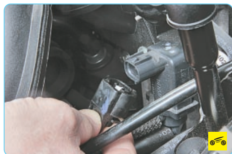
11. Отсоедините от клапана продувки адсорбера колодку жгута проводов...
