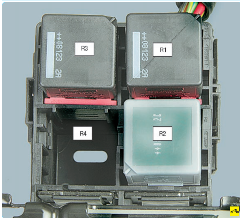
Рис. 10.3. Расположение реле в монтажном блоке, расположенном в подкапотном пространстве
