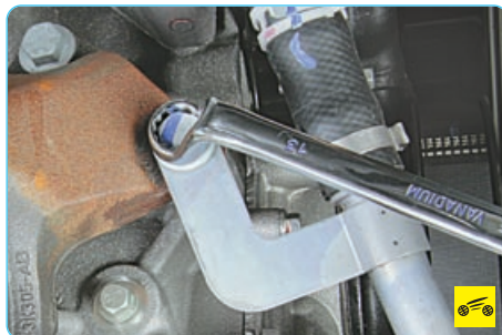
20. Выверните болты крепления к двигателю кронштейнов трубопроводов гидроусилителя рулевого управления.
