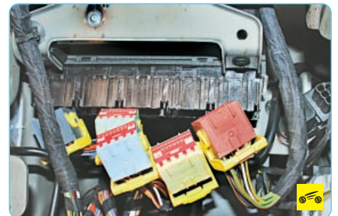
6. Аналогично отсоедините от блока GEM остальные колодки проводов.
