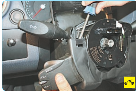
3. Подденьте отверткой фиксатор (для наглядности рулевое колесо снято)...
