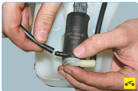
11. Отсоедините от штуцеров электронасоса шланги омывателя ветрового стекла...
