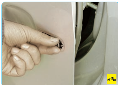
11. ...сожмите пластмассовые фиксаторы...
