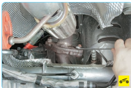
24. Отверните две гайки...
