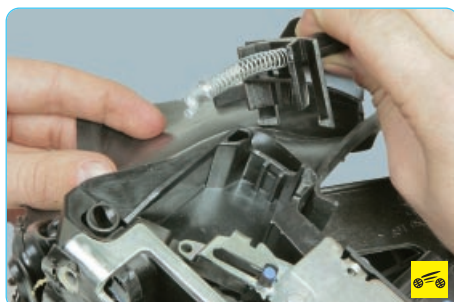
15. ...и извлеките наконечник троса привода замка.
