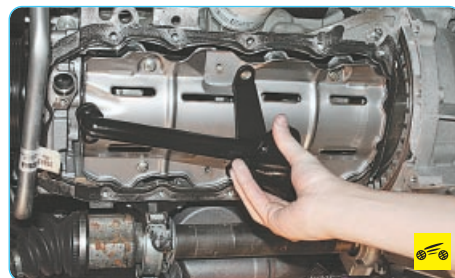
Рис. 5.35. Порядок затяжки болтов крепления масляного насоса
