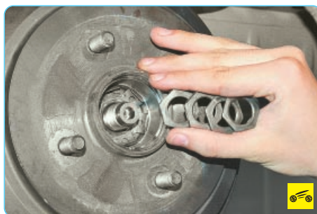
7. Окончательно отверните гайку ступицы...
