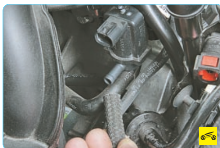
23. Отсоедините трубопровод от клапана продувки адсорбера.
