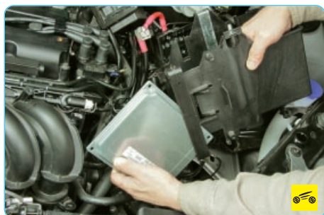
6. ...выведите из кронштейна полки ЭБУ и снимите полку.
