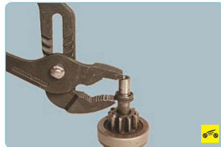
3. Для установки ограничительного кольца воспользуйтесь раздвижными пассатижами.
