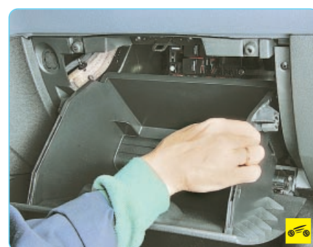
2. Выведите из панели приборов ограничитель хода вещевого ящика, сжав его стенки, и откиньте вещевой ящик вниз.
