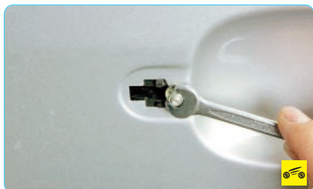
9. ...выверните гайку шпильки крепления замка двери к наружной панели двери...
