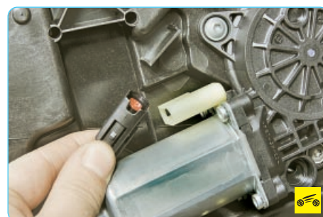
4. ...и отсоедините колодку от моторедуктора.
