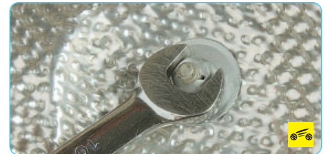
1. Отверните две передние гайки крепления переднего термоэкрана.
