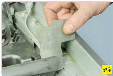
12. Снимите боковой пылезащитный щиток.
