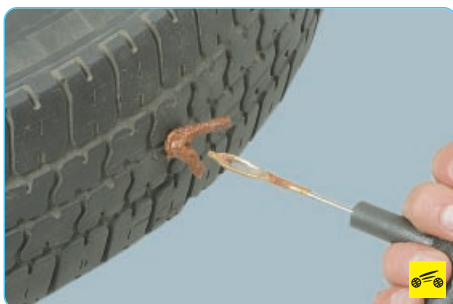
11. Резко выдерните иглу из отверстия.
