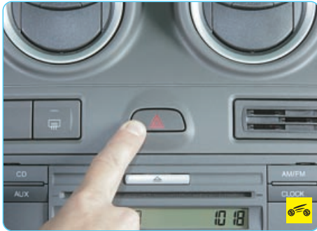
12 – выключатель аварийной сигнализации.
