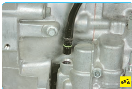
22. ...и выведите нижний конец направляющей трубки с уплотнительным кольцом из отверстия в картере коробки передач...
