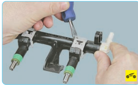
9. Отожмите отверткой концы фиксатора...
