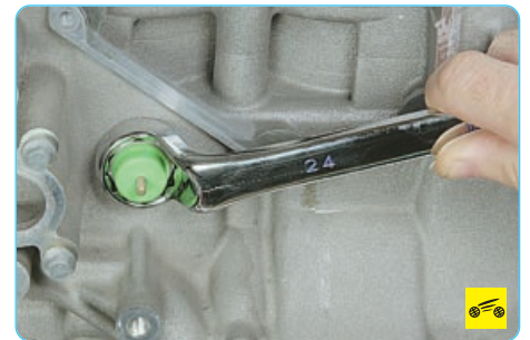
3. Выверните датчик из блока цилиндров...
