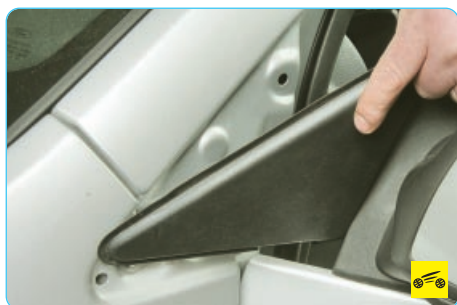
8. Поддев отверткой, снимите декоративную накладку переднего крыла...
