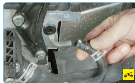
27. Сжав пассатижами хомут и сдвинув его по шлангу, отсоедините компенсационный шланг системы охлаждения от патрубка головки блока цилиндров.
