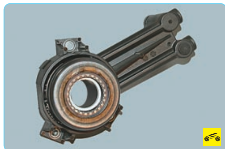
Рис. 6.2. Подшипник выключения сцепления, объединенный с рабочим цилиндром привода выключения сцепления: 1 – картер сцепления; 2 – подшипник выключения сцепления; 3 – рабочий цилиндр привода выключения сцепления; 4 – болты крепления рабочего цилиндра привода выключения сцепления
