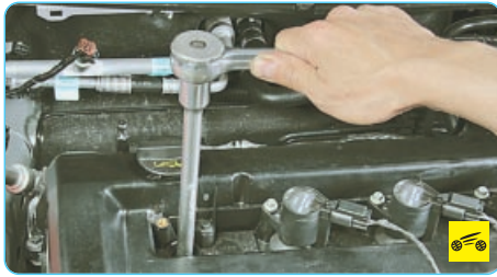
4. Выверните болт крепления...
