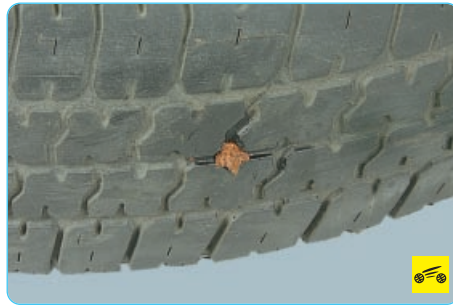
13. Подождите указанное в прилагаемой к ремонтному набору инструкции время, необходимое для полимеризации клея, и накачайте колесо до рекомендуемого давления.
