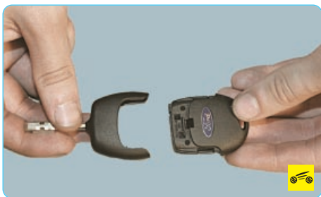
2. ...и разъедините блок дистанционного управления и держатель ключа.
