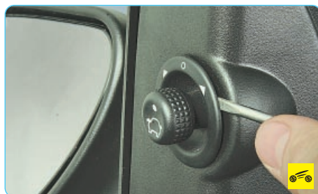
2. Аккуратно подденьте отверткой блок управления наружными зеркалами...
