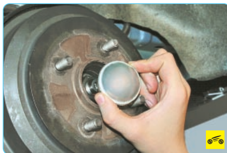
5. ...и снимите защитный колпак подшипника ступицы.
