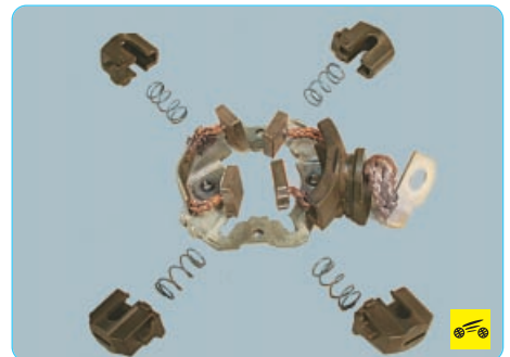
14. При необходимости снимите корпуса щеток и пружины.
