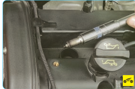
5. ...и извлеките ее из свечного колодца.
