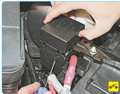
2. Отожмите отверткой два фиксатора, расположенные по бокам крышки...
