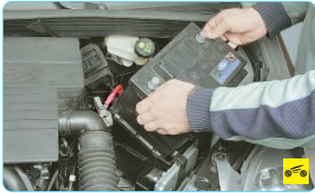
1. Снимите аккумуляторную батарею (см. «Снятие и установка аккумуляторной батареи», с. 211).
