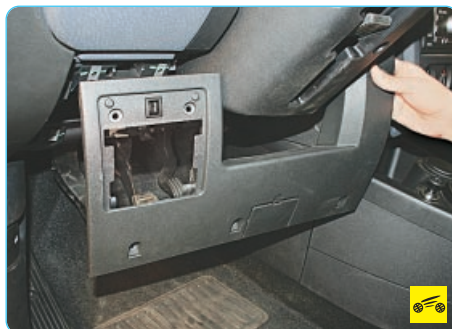
2. Снимите нижнюю декоративную накладку панели приборов (см. «Снятие и установка панели приборов», с. 293).
