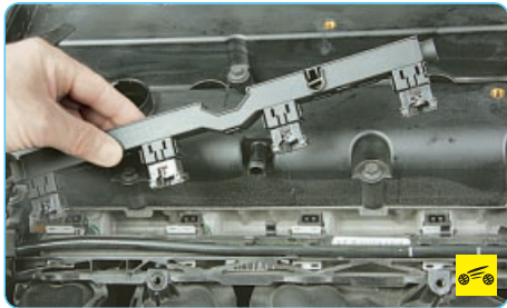
5. ...и отсоедините от форсунок колодки жгута проводов.
