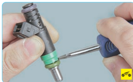
12. Для замены уплотнительных колец форсунок подденьте их отверткой...
