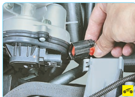
5. ...и отсоедините колодку жгута проводов от крышки дроссельного узла.
