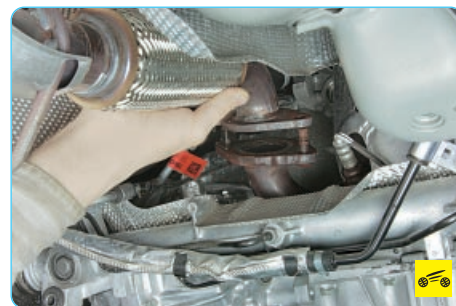
25. ...и разъедините фланцы катколлектора и приемной трубы.
