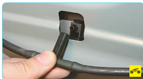
17. Для замены жиклера омывателя отсоедините шланг от штуцера жиклера.
