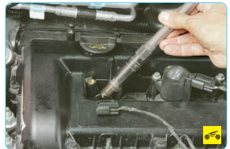
4. Выверните свечи зажигания и извлеките их из свечных колодцев.
