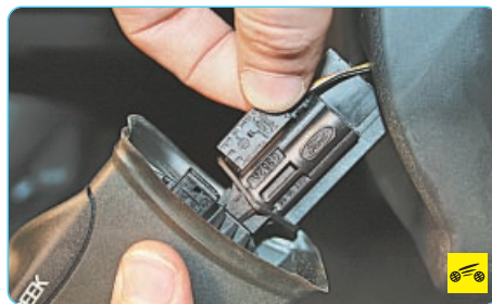
5. Отсоедините колодку жгута проводов от пульта управления и снимите пульт.
