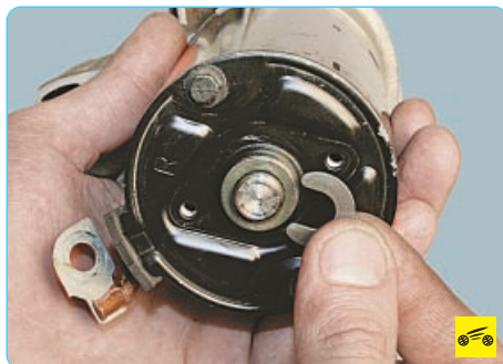
9. Снимите стопорное кольцо...
