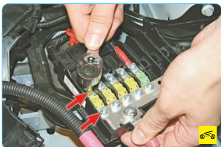
5. Отверните две гайки крепления...
