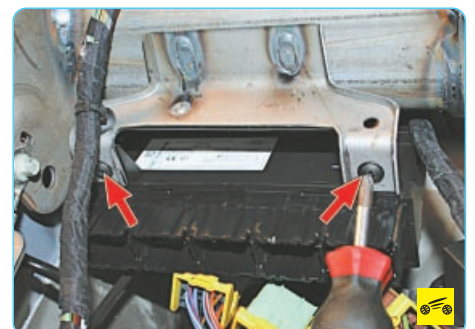
7. Выверните два винта...
