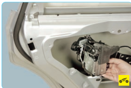
12. ...и снимите замок с двери.
