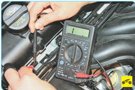
6. Автомобильным тестером в режиме омметра измерьте сопротивление обмотки форсунки. При 20 °С оно должно составлять 14 Ом. Если сопротивление обмотки форсунки не соответствует норме, замените форсунку, так как она неремонтопригодна.
