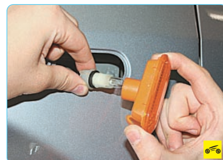
4. Снимите боковой фонарь указателя поворота (см. «Замена бокового фонаря указателя поворота», с. 237).
