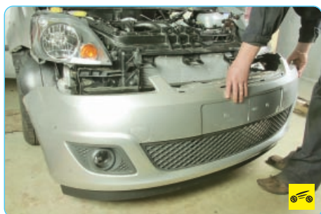
10. Снимите передний бампер (см. «Снятие и установка переднего бампера и его бруса», с. 264).
