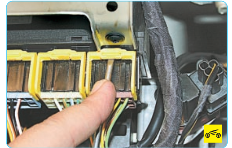
3. Подденьте отверткой и отожмите фиксатор...
