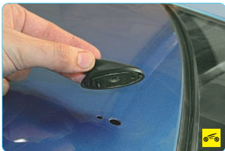
5. ...и снимите кронштейн антенны.
