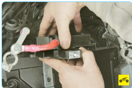
10. Для снятия полки аккумуляторной батареи отожмите фиксатор...
