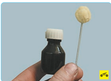
12. Нанесите грунт по периметру стекла и проема окна.
