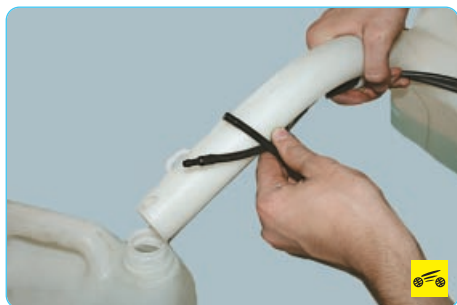
10. Слейте жидкость из бачка омывателя в заранее подготовленную емкость.
