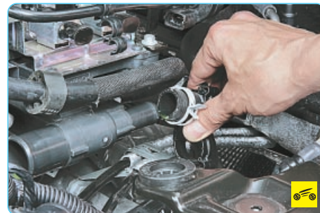
17. Отсоедините от распределителя охлаждающей жидкости шланг отопителя салона и подводящий шланг радиатора системы охлаждения двигателя.
