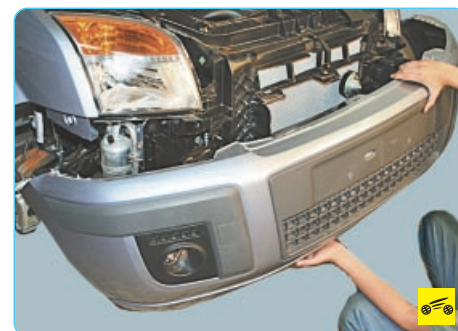
5. Снимите передний бампер (см. «Снятие и установка переднего бампера и его бруса», с. 264).
