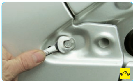
9. ...и выверните болт крепления крыла к боковой поверхности передней стойки кузова.
