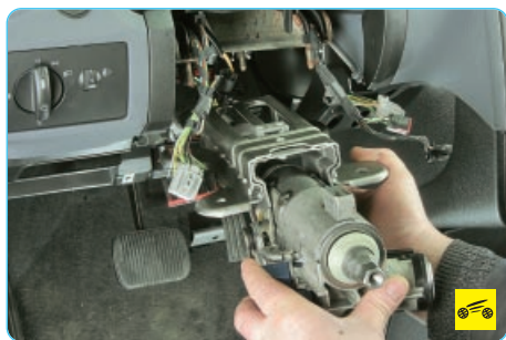
5. Выверните два винта крепления электронного блока управления...
