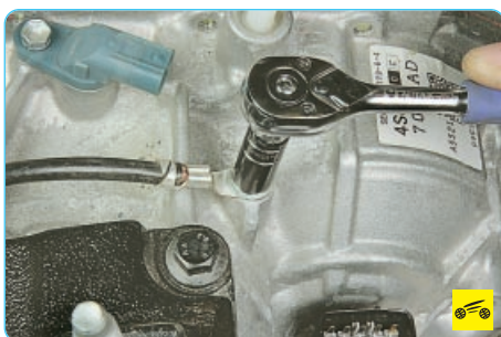
17. Выверните болт крепления...
