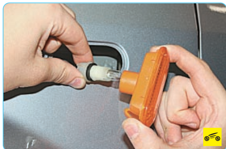
7. Снимите боковой фонарь указателя поворота (см. «Замена бокового фонаря указателя поворота», с. 237).
