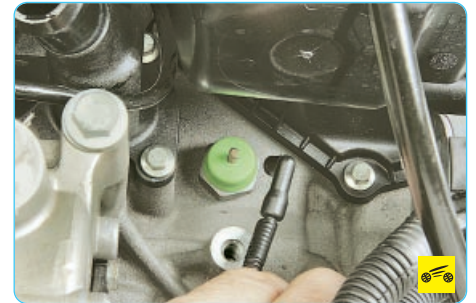
2. Отсоедините от датчика сигнальной лампы аварийного падения давления масла наконечник провода.
