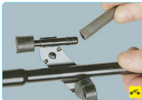
22. ...и выведите нижний конец направляющей трубки с уплотнительным кольцом из отверстия в картере коробки передач...
