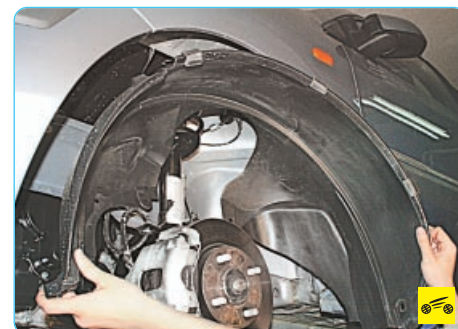
3. ...и передний подкрылок (см. «Снятие и установка брызговиков и подкрылков», с. 261).
