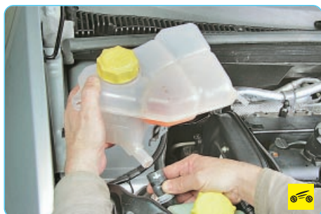
15. Снимите расширительный бачок системы охлаждения (см. «Снятие и установка расширительного бачка», с. 117).
