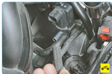
12. ...и трубопровод адсорбера.
