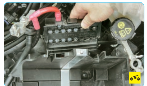
3. ...и ответите в сторону соединительную колодку.
