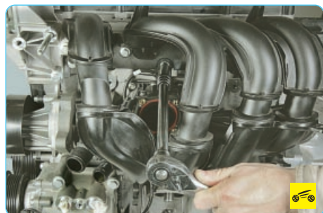
13. Выверните шесть болтов крепления впускного коллектора...
