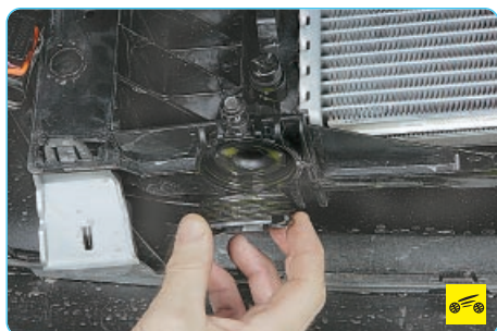
11. ...и отверните крепление.
