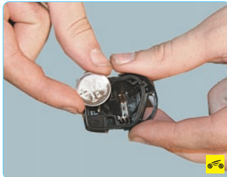
6. ...и извлеките батарейку из корпуса блока дистанционного управления.
