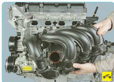
14. ...и снимите впускной коллектор.
