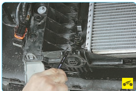
9. Выверните стопорный винт...
