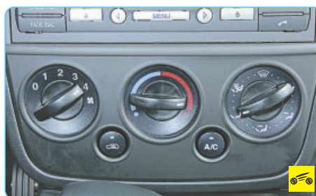
18 – блок управления системой отопления (кондиционирования) и вентиляции салона, см. «Отопление (кондиционирование) и вентиляция салона», с. 25.
