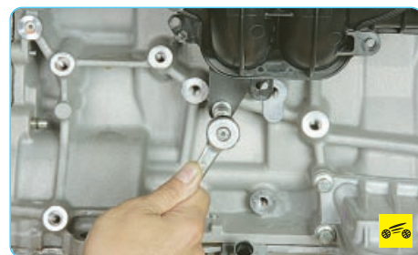
9. Выверните восемь болтов крепления впускного коллектора...
