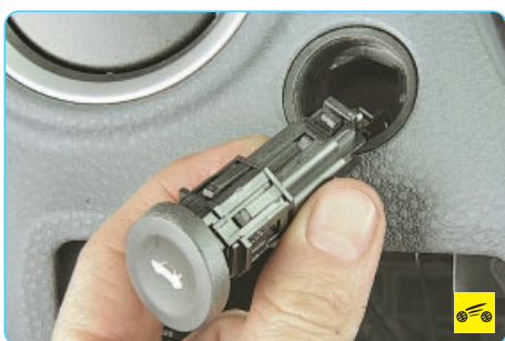
6. ...и извлеките выключатель наружу.
