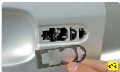
8. Снимите уплотнитель ручки...
