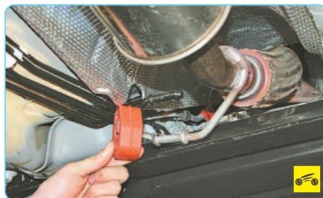
6. Подденьте отверткой и сдвиньте подушку с переднего кронштейна дополнительного глушителя.
