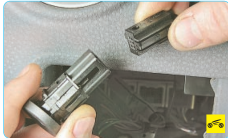
8. ...отсоедините колодку жгута проводов от выключателя электропривода замка багажника и снимите выключатель.
