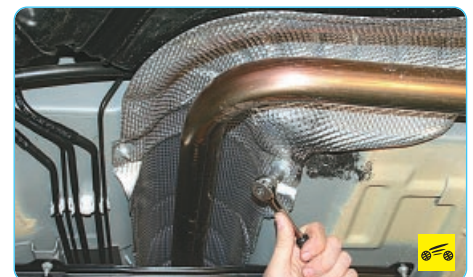
2. Отверните две гайки крепления термоэкранов в средней части кузова и снимите передний термоэкран.
