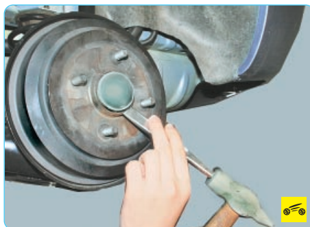
4. С помощью зубила спрессуйте...
