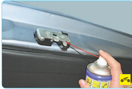
10. Защелка замка (силиконовая смазка в аэрозольной упаковке)...
